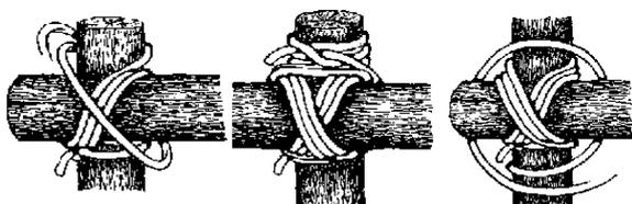
On commence le brèlage diagonal par attacher la corde à l'une des perches, ce qui se fait souvent avec un nœud de cabestan ou un nœud. Il s'agit ensuite de passer 3 fois dans chaque diagonale, et de finir par un autre cabestan ou par un autre nœud plat (on attache le brin libre sur le dormant)
